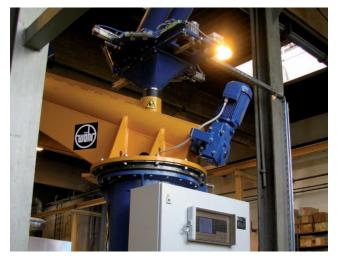
Technische Daten des Durchlaufwirbelmischer 3-10t/h
