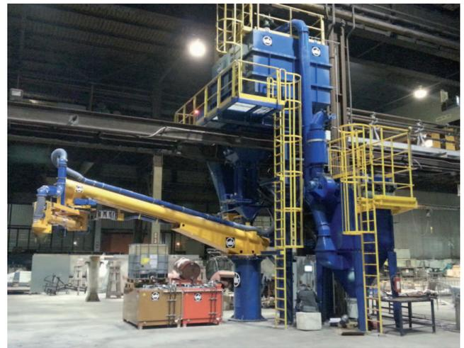
Technische Daten des Durchlaufwirbelmischer 3-10t/h
