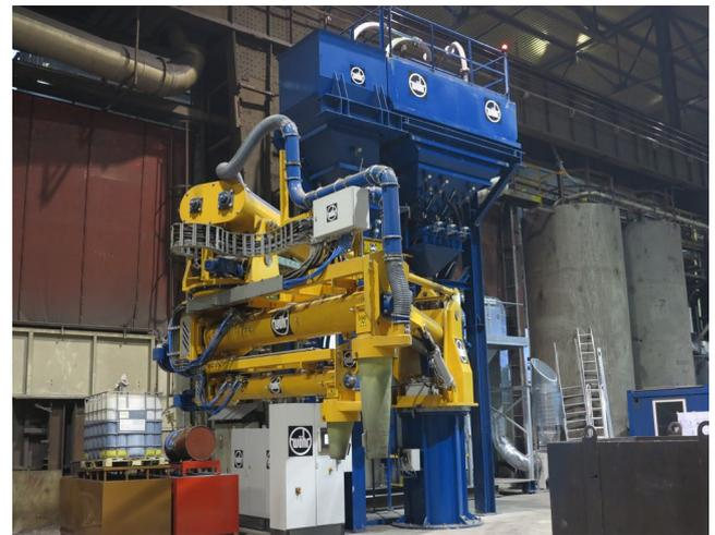
Technische Daten des Durchlaufwirbelmischer 3-40t/h
